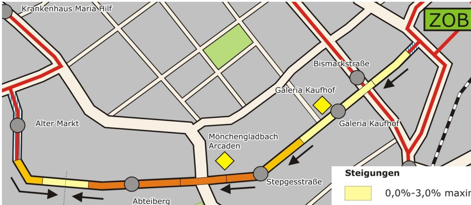
**→ Rampen mit Längsneigung > 6% sind im öffentlichen Bereich als NICHT-barrierefrei anzusehen! (DIN 18024 bzw. DIN 18040-1)**
